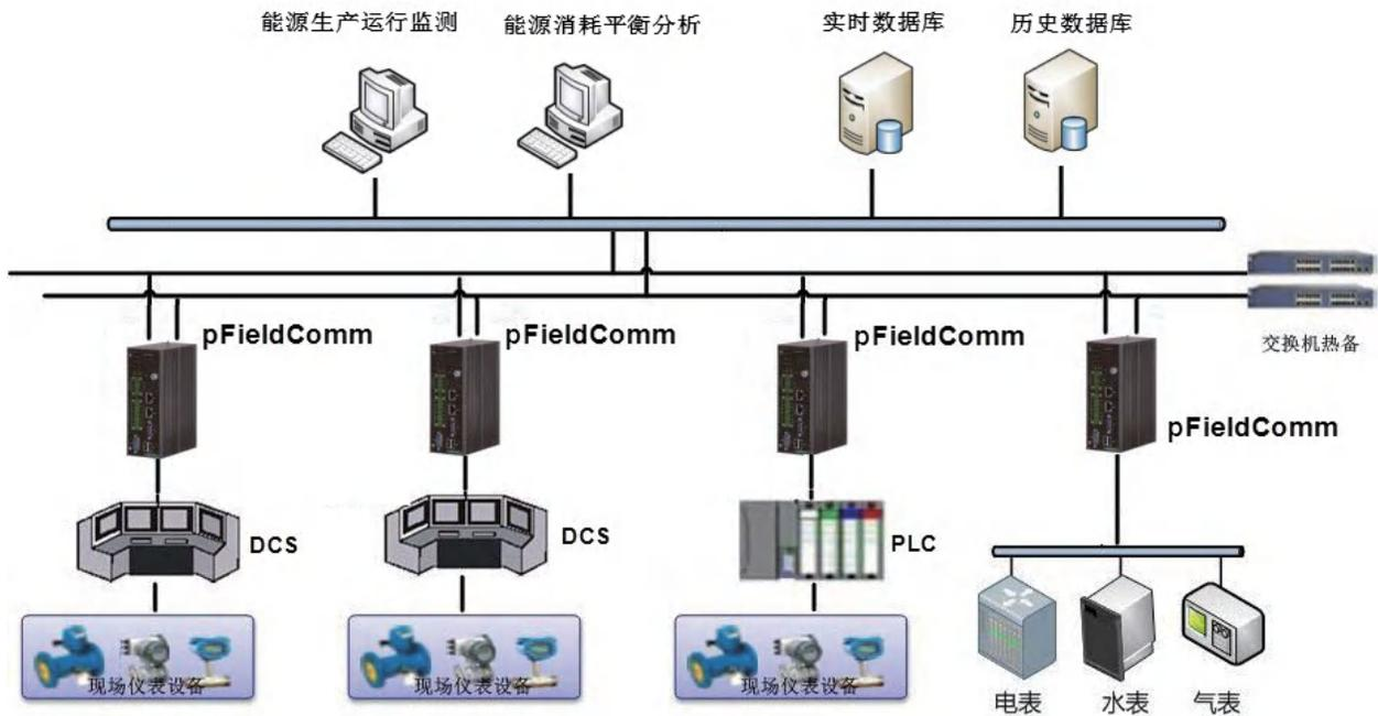
在冶金、石化、发电厂企业的能源管理系统及信息化建设过程中,存在着大量的不同厂家和不同通讯方式的过程设备。过程设备与实时数据库服务器之间的实时数据通讯无论从数据质量上还是数据的完整性上都存在着很多问题。集中表现在以下三个方面:
